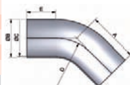
PharmCom-Bogen 45° ISO DIN 11865-BL-B
